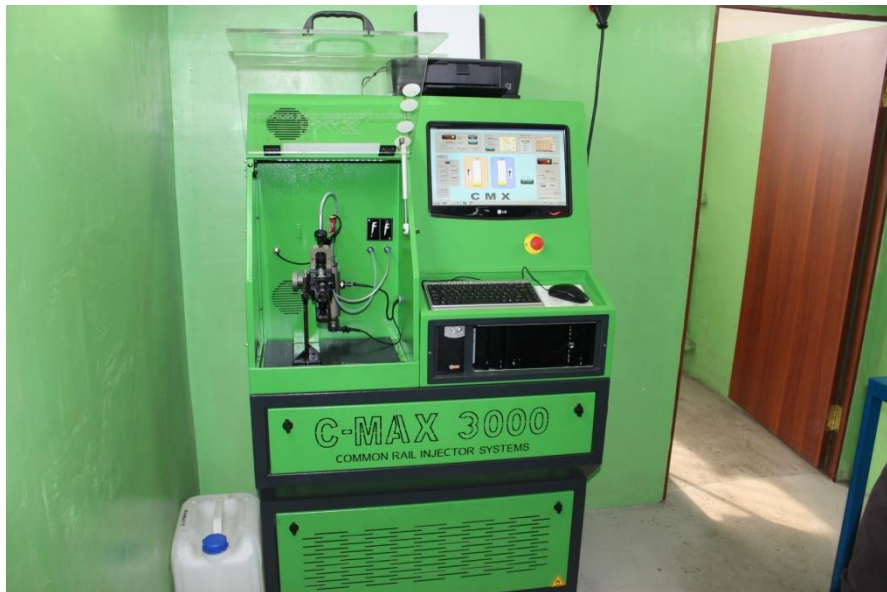
Стенд настройки топливной аппаратуры
