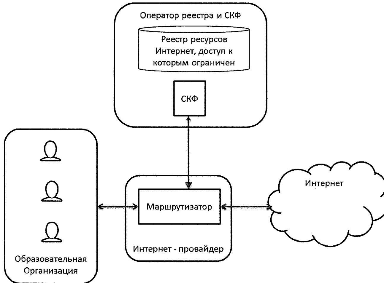
Рисунок 5. Схема работы контент-фильтрации при едином решении
